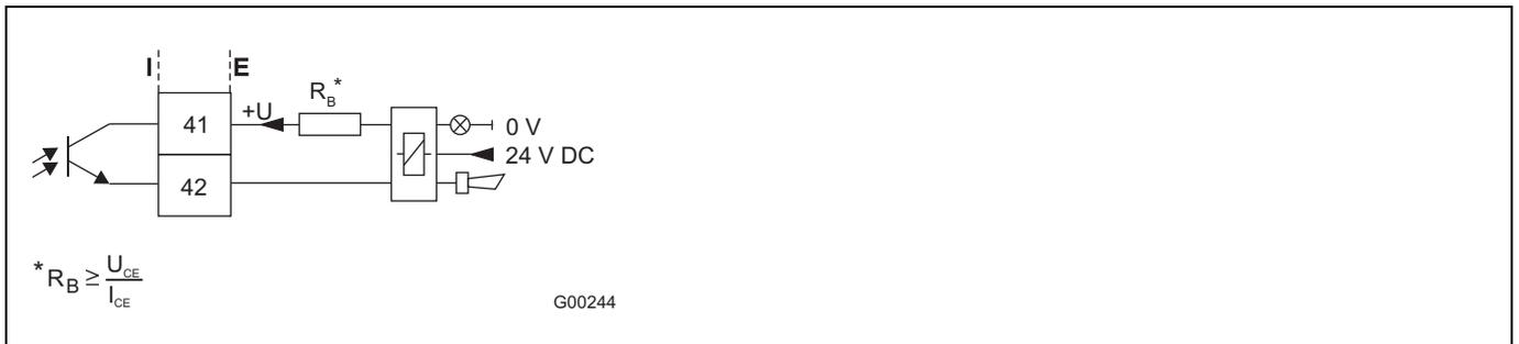
Fig. 21: Salida de contacto para el control del sistema, alarmas máx./mín. tubería vacía o señalización de directo/inverso
